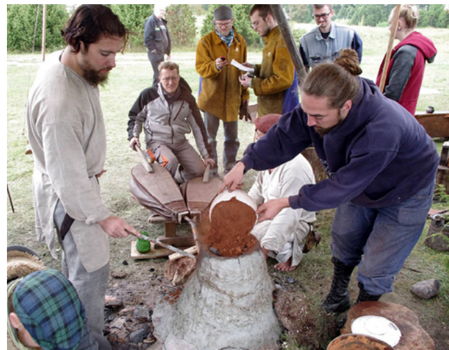
Pilt 2. Rauasulatusahju pannakse Rõuge maak. Foto Mart Kekišev.
