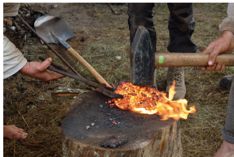
Pilt 5. Ahjusooja tooraua sepi-amine kangiks. Foto Mikk Freiberg.
