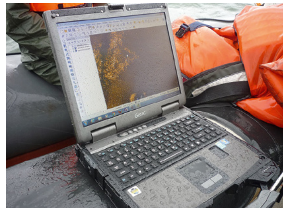
Pilt 4. Välitöödel peab hea varustus olema. Arvutiekraanil on Tsitadelli georefereeritud sonaripildid, mida kasutati roboti juhtimiseks. Fotod Priit Lätti.
