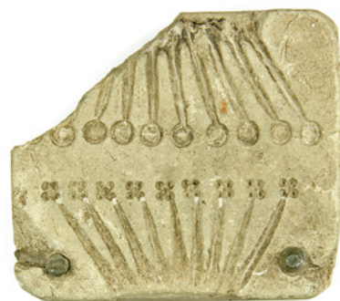
Pilt 1. Valuvorm ehk valamisvorm – kivist, savist või metallist vorm, mille sisse valati sulametal (Ragnar Saage). Foto Edgar Laks.
