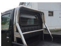
ハイゼットトラック ダブルチューブロールバー (ステンレス)
