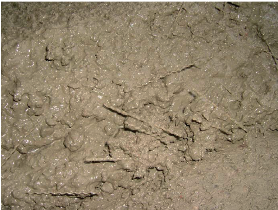
Kuva 4 Makrokuituja tuoreen betonin seassa. (Kuva: Martti Matsinen)
