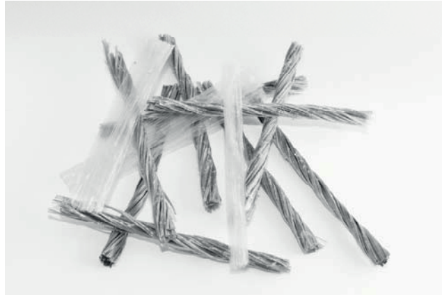
Kuva 5. Esimerkki valmiista mikro – ja makropolymeerikuidun sekoituksesta.
