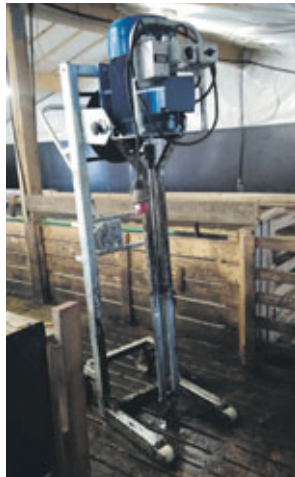
Innihæfur fyrir gripahús. Rafdrifnar : 7,5 kw, 9,2 kw, 11 kw glussadrifnar : 8 kw, 60 l / min., 120 bar. Vinnudýpt : 130 cm skrúfa : 200 mm. Hákonarson ehf. Uppl. í síma 892-4163, hak@hak.is, www.hak.is.
