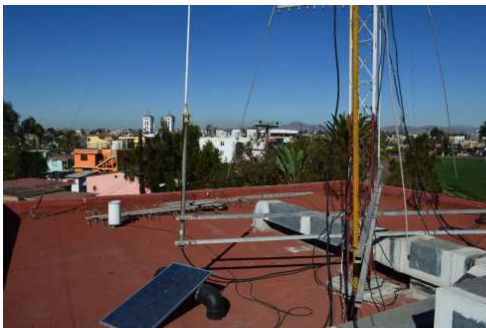
Figura 4-4 Pluviómetro ubicado en las instalaciones de Protección Civil del Municipio de Tijuana (PC-02).
