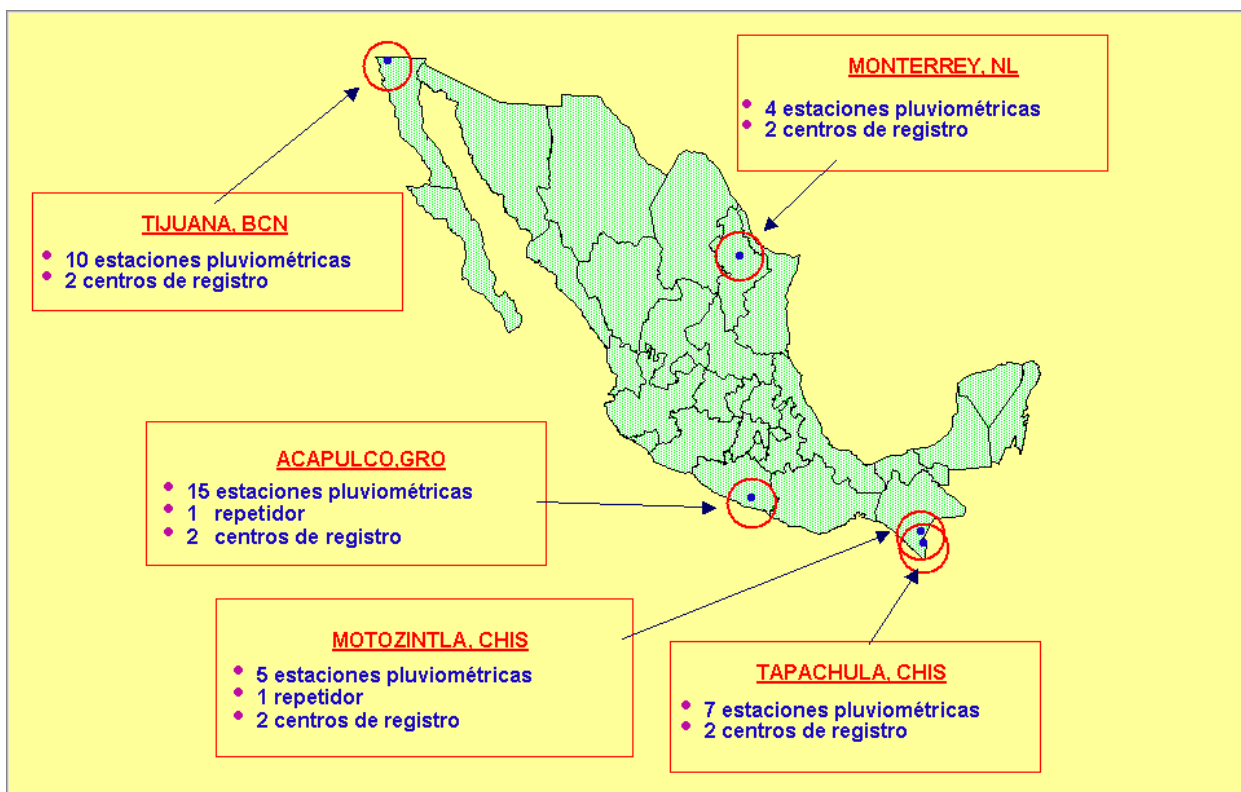
Figura 3-27 Sistemas de Alerta Hidrometeorológica instalados entre 1998 y 1999.
