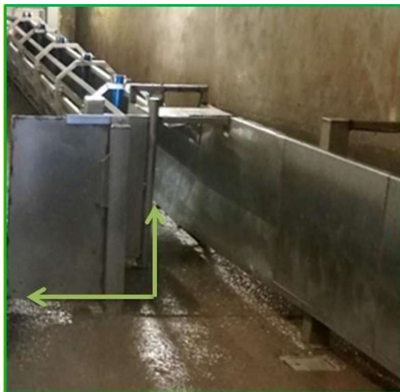
左: テンプル・グランディン氏によるオフセット・ステップのデザイン、右: オランダのと畜場のオフセット・ステップ
