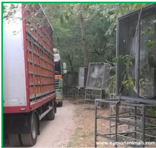
停車しているトラックを換気するための大型の可動式扇風機により暑熱ストレスを軽減する
