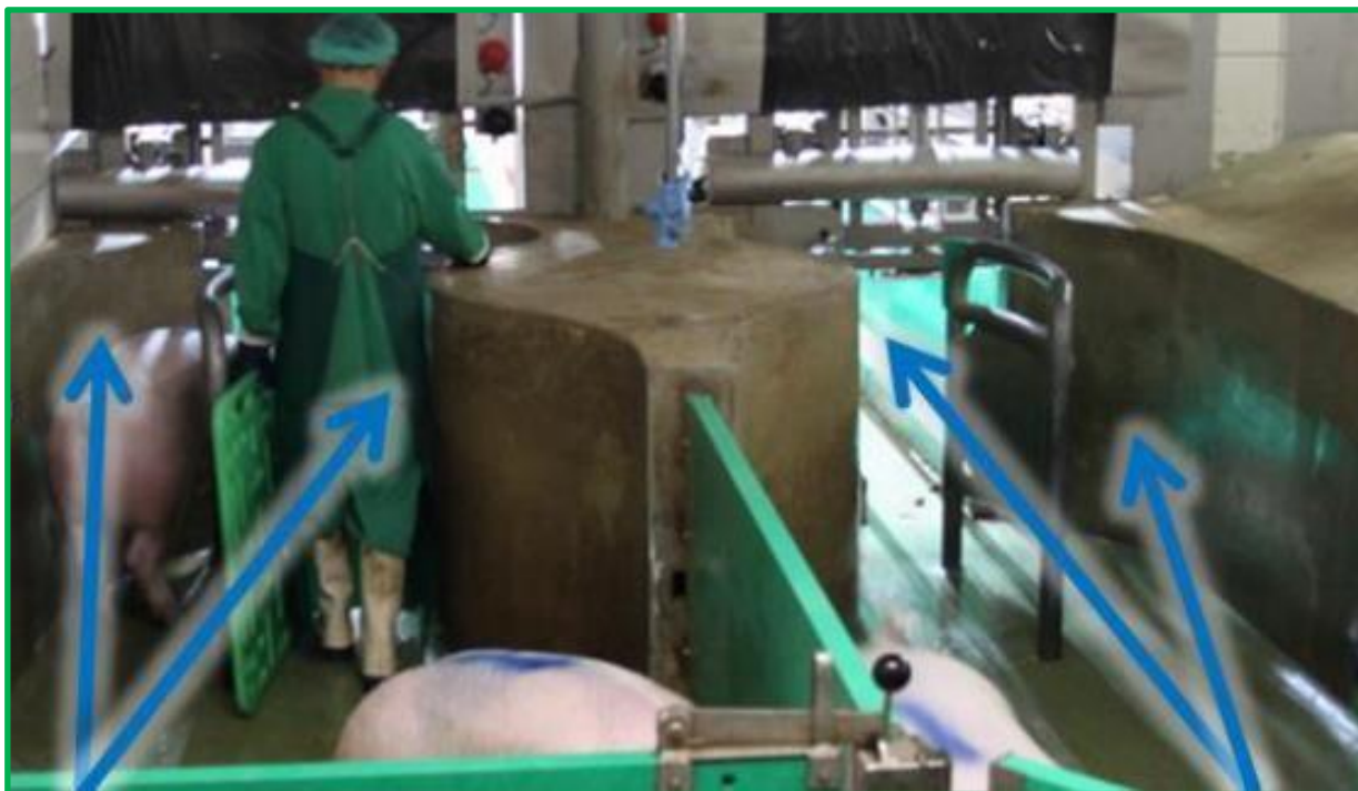
Grossfurtner (オーストリア)のストレスを軽減する2つの入口のある誘導路
