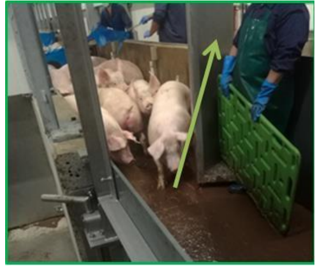
豚が通過するときに作業員が後ろに隠れることができるWestfort社のと畜場の誘導路のパネル
