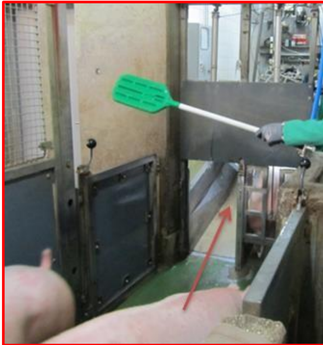
上向きの傾斜の誘導路は豚の移動を困難にする
