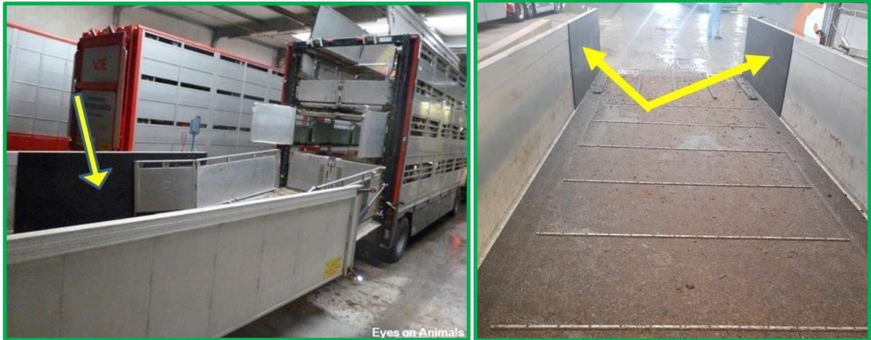
Zevenaer (オランダ) のCompaxo社のと畜場の(金属同士の接触による)騒音を低減するゴム製パネル
