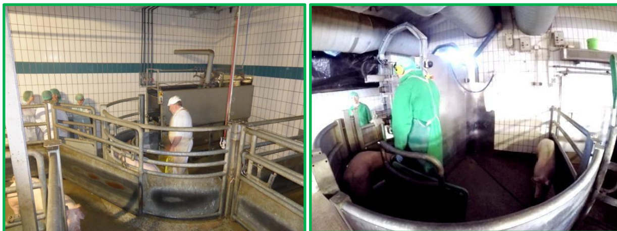
Naturverbund (左)とGrossfurtner (右)の豚の円形の2つの入口がある誘導路
