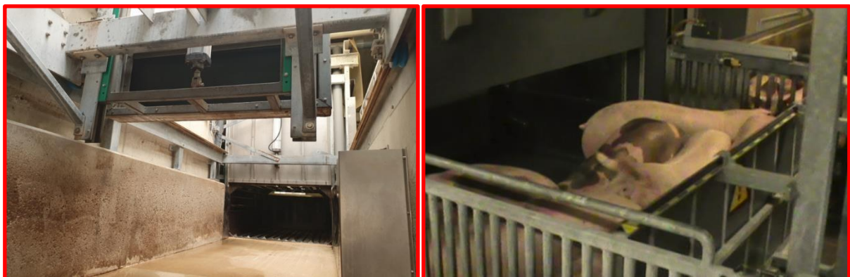
CO2ケージが暗すぎる。豚は入るのを怖がり、反対側に行こうとする。その結果、自動ゲートは豚を不快な方法で押し出す。
