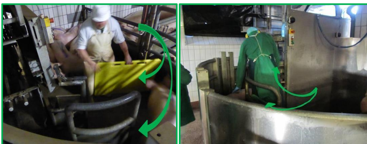
Naturverbund (ドイツ)とGrossfurtner (オーストリア)のストレスを軽減するための2つの入口のある誘導路
