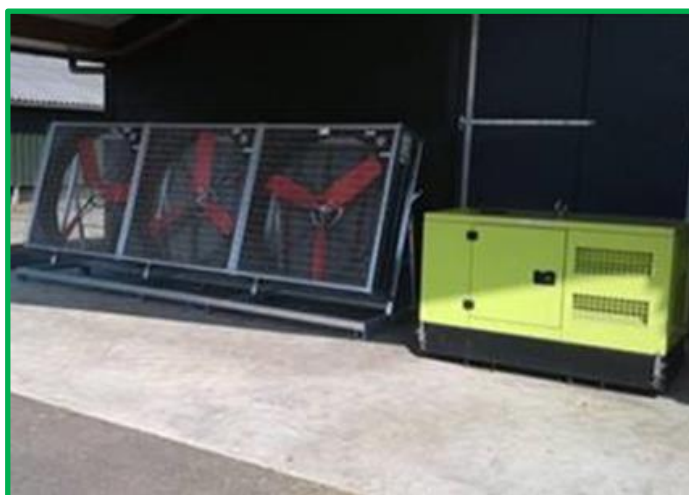
停車しているトラックを換気するための大型の可動式扇風機により暑熱ストレスを軽減する
