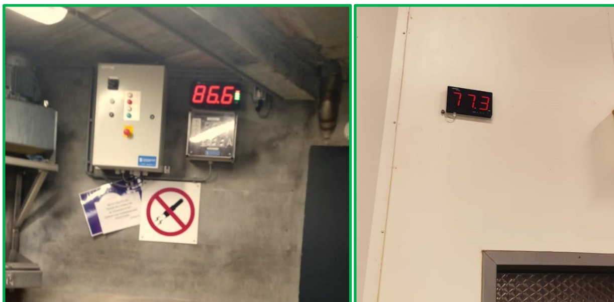
オランダのと畜場での騒音計。左:積み下ろし場で86.6 dB、右:けい留所で77.3 dB。
