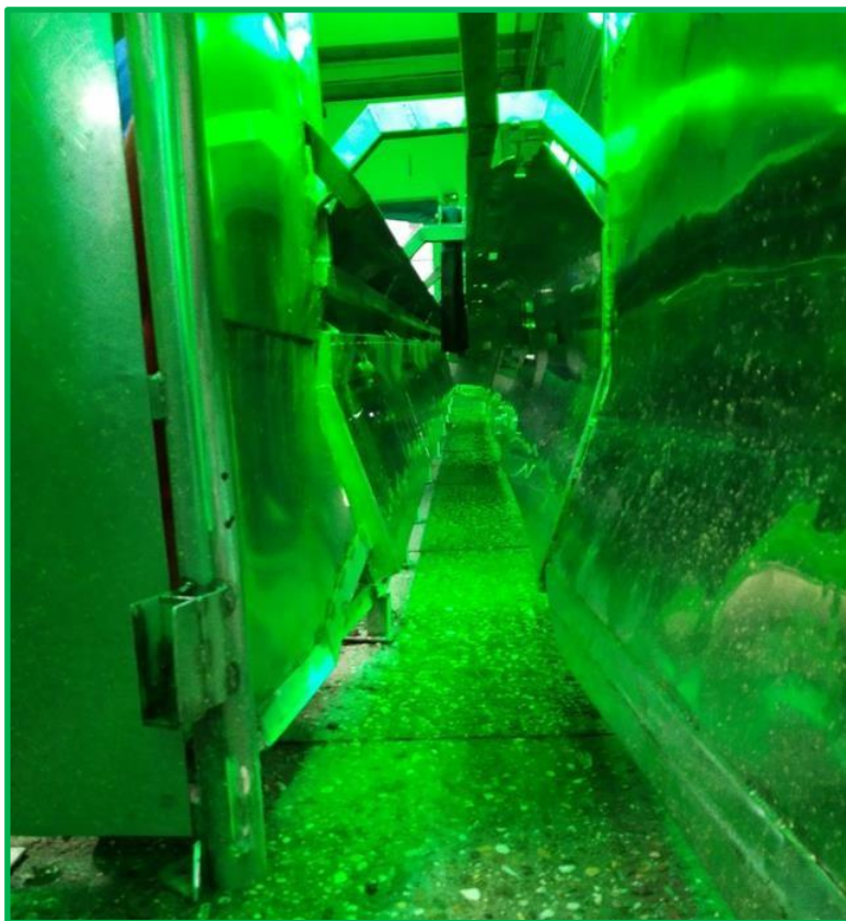
誘導路の反射は、豚を立ち止まらせ混乱させる。
