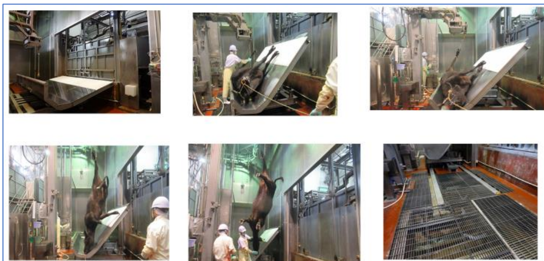
図表 25 可動式と体受台方式（②）におけると体受台の改良
