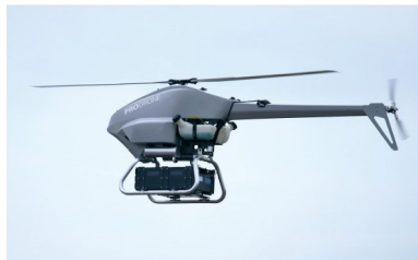
最大2時間200Kmの飛行が可能なシングルロータードローン
