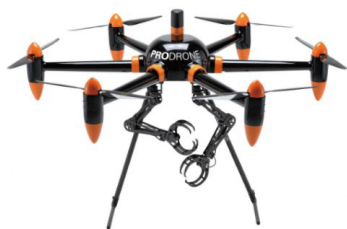
世界初の2本のロボットアームをもつドローン
