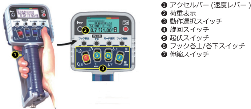
図1-62 積載形トラッククレーンの遠隔操作装置(ラジコン方式)(例)
