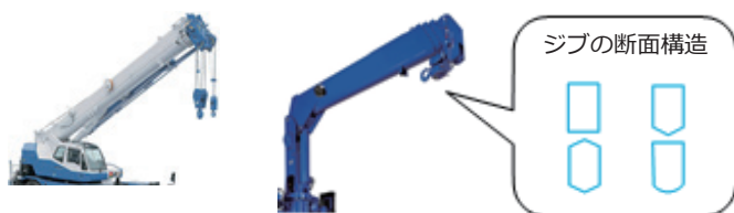
図1-20 箱型構造ジブ
