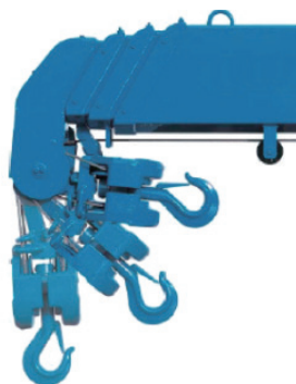
図1-45 フック格納機構
