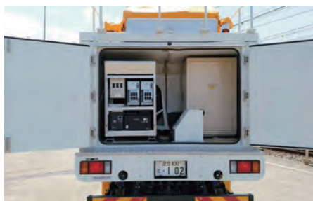
電気検測車に搭載された機器
