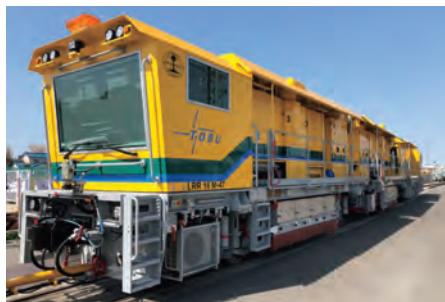
レールの表面を削るレール削正車
