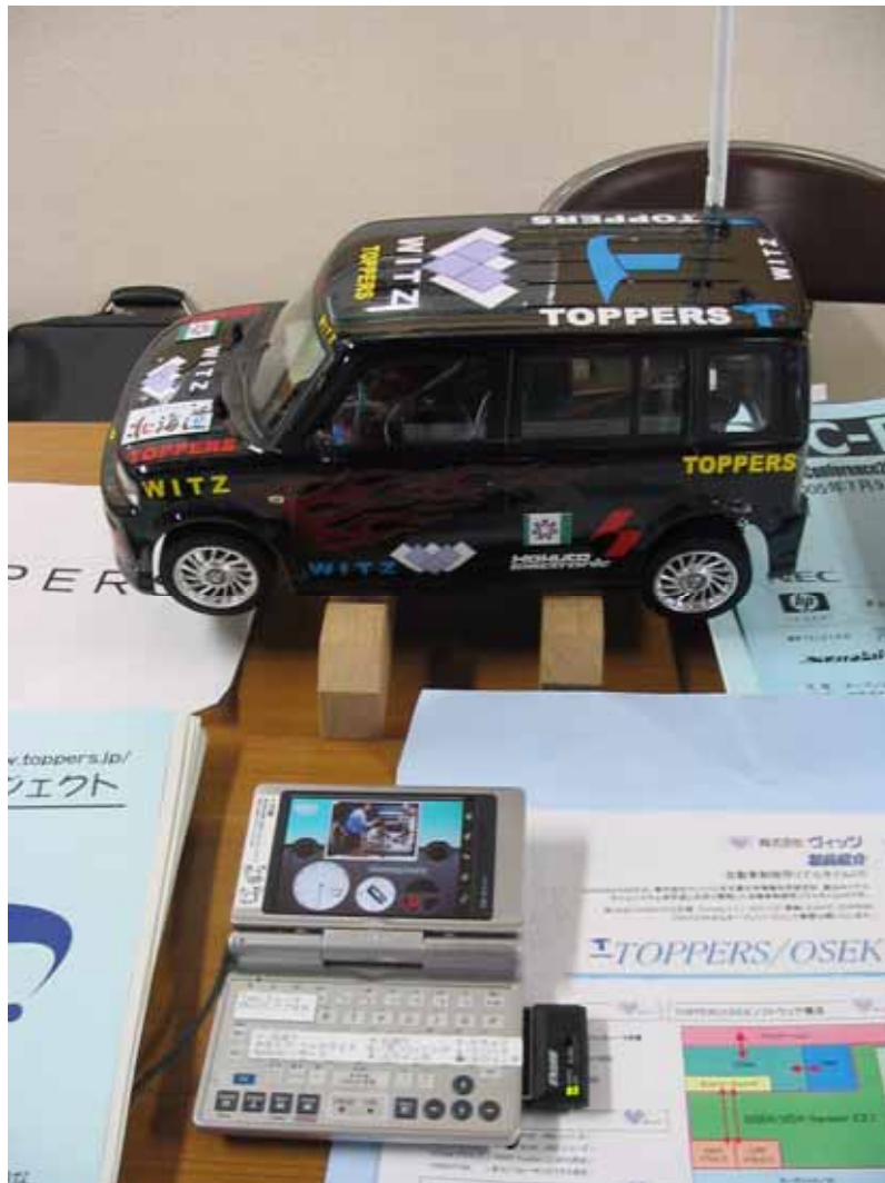
PDAから無線で捜査中、カメラ映像も取得可
