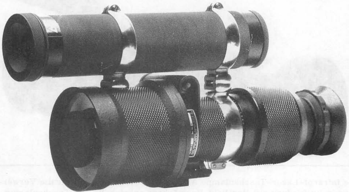
ARGUS Infrarot-Laser-Taschenlampe Typ LT3 montiert auf Smith & Wesson Restlichtverstärker MK 303A
