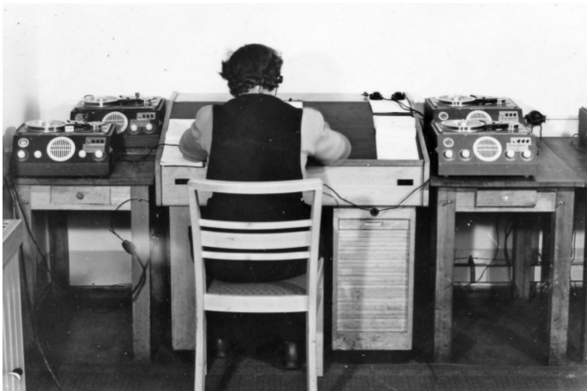
Die Kontrolleurin an der Anlage für 20 Leitungen mit 4 Tondrahtgeräten Reichhalter „Reporter“, das Bedienfeld ist verdeckt.
