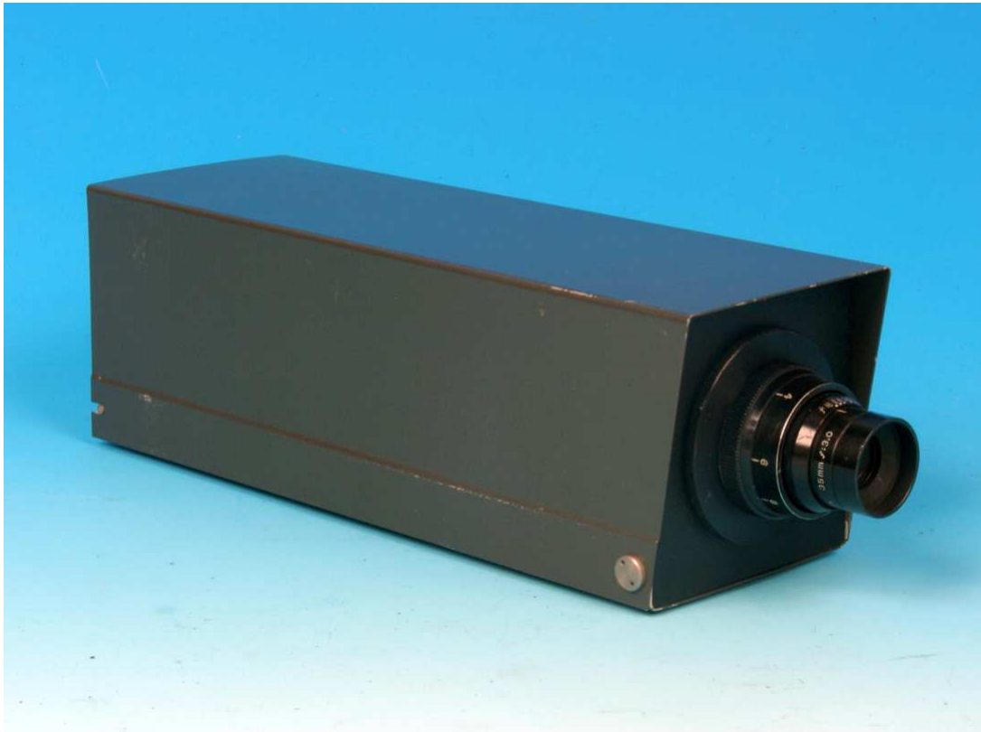
Eine TVKK 1 (TV Kleinstkamera) mit statischer Ablenkung, speziell für das MfS in Radeberg gebaut
