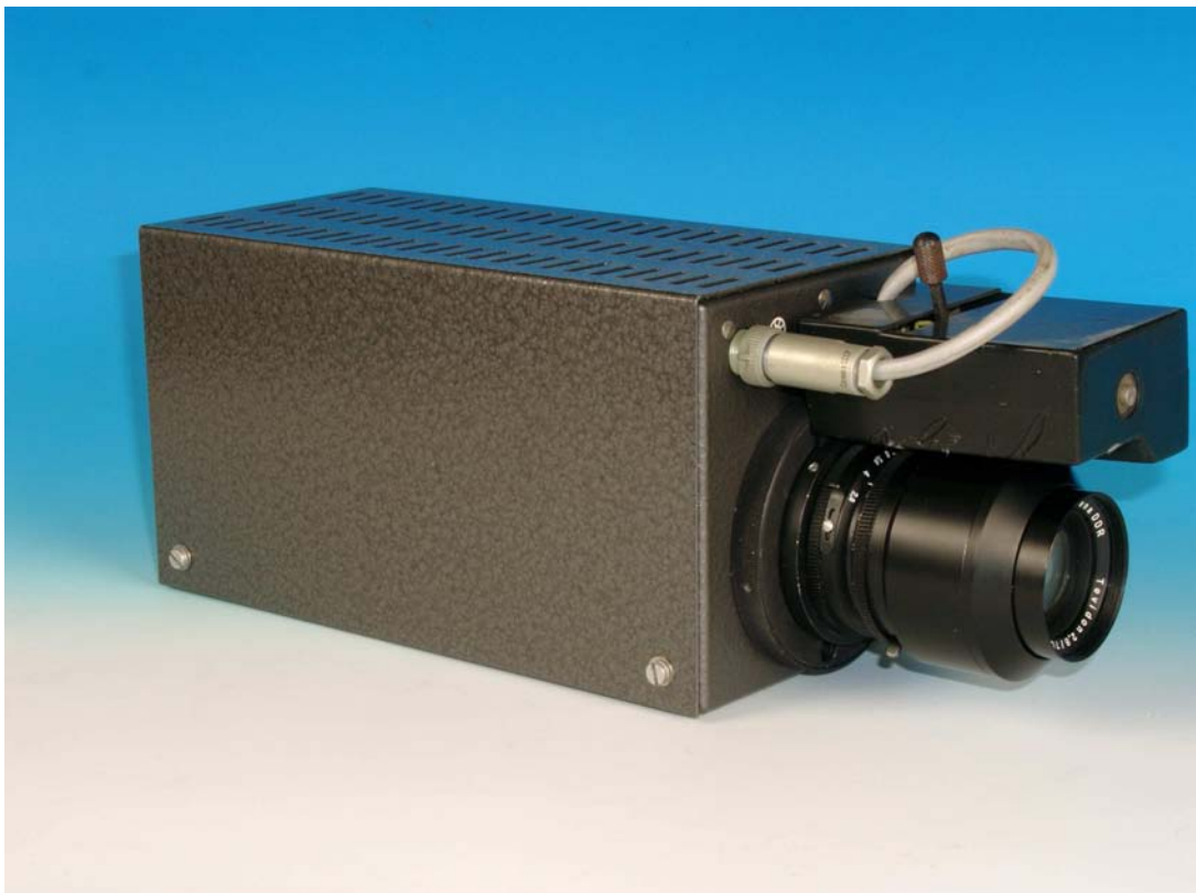
Eine TVKK 3 (TV Kleinstkamera) mit Tevidon mit automatischer Blendensteuerung, ebenfalls in Radeberg speziell für das MfS gefertigt
