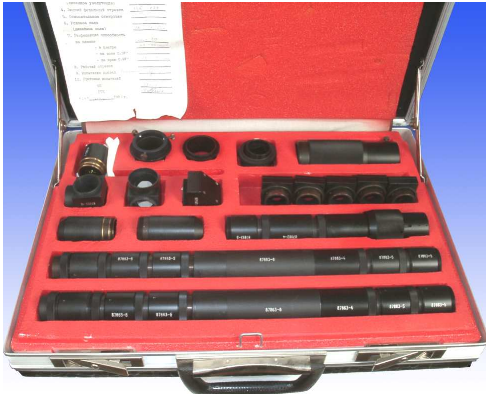
Ein russisches Nadelöhrobjektiv „Schofrej“, das verwinkelte Strahlengänge ermöglicht.
