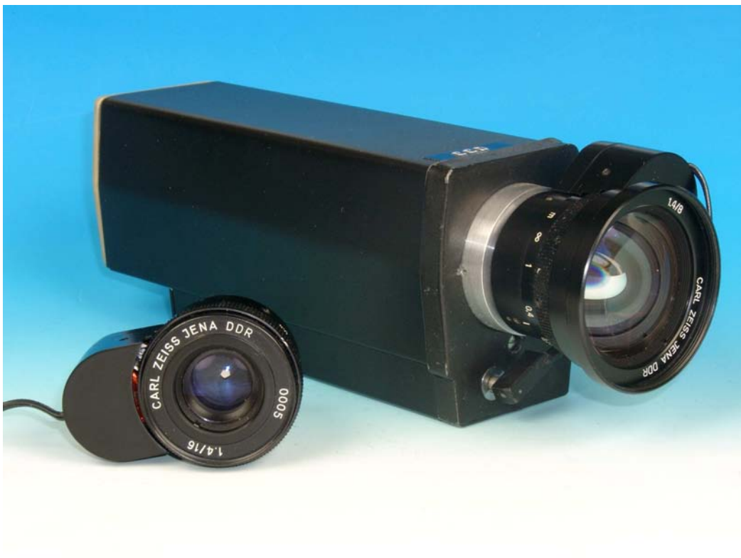
Prototyp einer 2/3" CCD-Kamera MFK 5010 mit voller Fernsehauflösung, deren Entwicklung vom OTS angestoßen worden ist. Dazu wurde auch eine neue Tevidon-Objektivreihe mit integriertem Blendenantrieb entwickelt.
