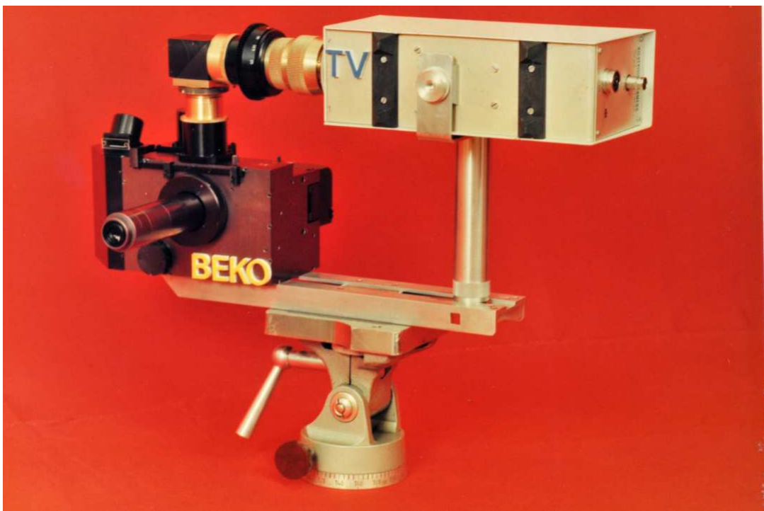
Ein Beko II mit ungarischer Restlichtkamera TV11-22 zur Übertragung des Sucherbildes zu einer Zentrale
