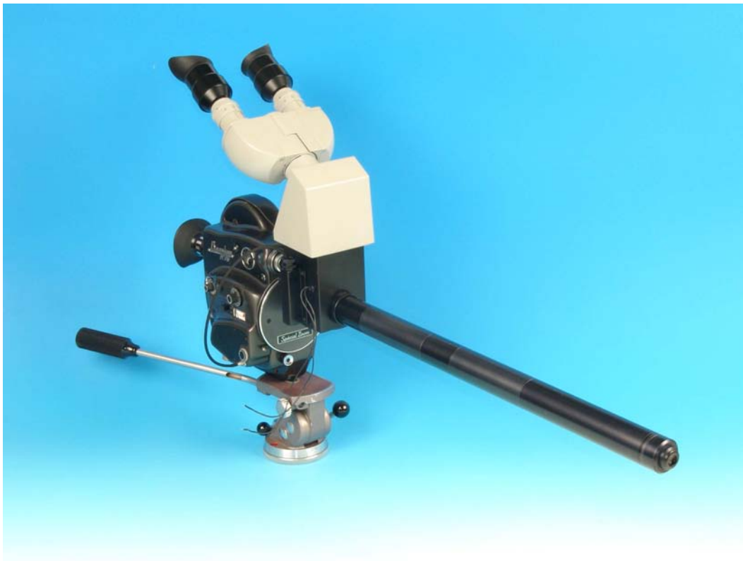
Eine Beaulieu R16 mit einem Spiegelkasten zum Beobachten
