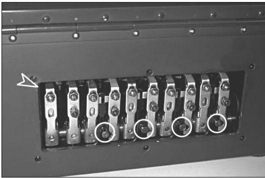
123 "Service-Öffnung" auf der Rückseite der Nema. Die zehn Zungen, welche die Walzen weiterdrehen sind zu erkennen. Der Pfeil zeigt auf den Hebel 'A' der Abb. 126. [AUT]
