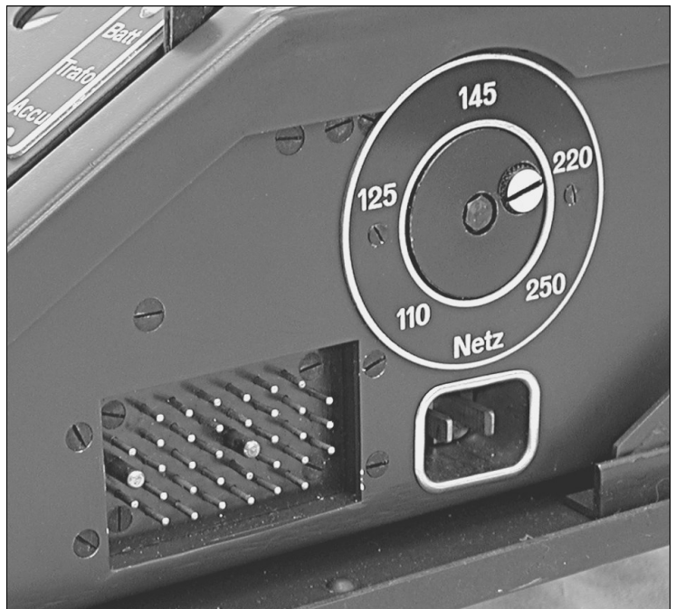
70 Netzspannungs-Wahlschalter, Netzanschluss und Steckdose für das Lampenfeld. [AUT]
