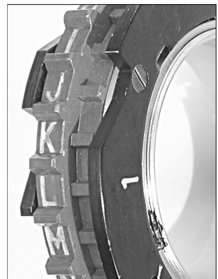
132 Die Zahnscheiben mit einstelliger Nummer werden rechts an der roten Walze befestigt. Die Nummer muss bei 'L' zu liegen kommen. [AUT]
