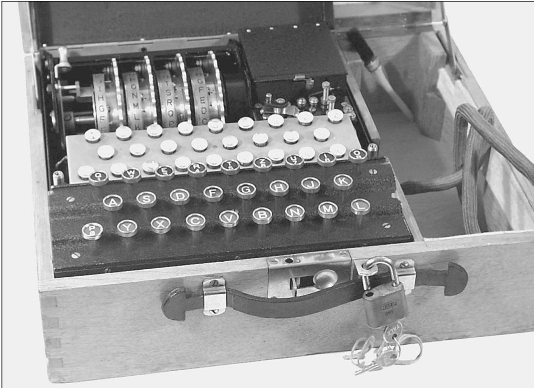
100 Die kommerzielle Enigma, Modell K. Sie wurde während des Krieges in der Schweizer Armee und im Verkehr mit den Botschaften eingesetzt. Die Maschine ist mit vier Rotoren ausgerüstet und hat kein Steckerbrett. Rechts das Fach für das Zusatzlampenfeld. [GSB]
