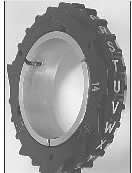
131 Die Zahnscheiben mit zweistelliger Nummer werden links an den Fortschaltwalzen angeschraubt. Die Nummer muss bei 'U' zu liegen kommen. [AUT]
