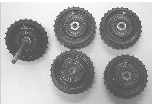
96 Die Kontaktwalzen und die Umkehrwalze 'A' der selben Maschine 117. [AUT]
