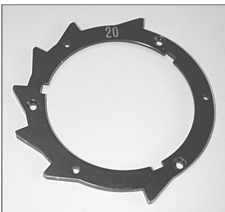
120 Eine Zahnscheibe, sie wird an die Fortschaltwalze geschraubt. [AUT]
