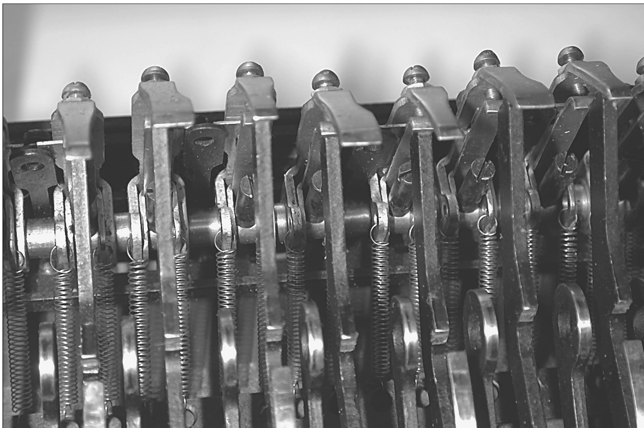
127 Blick aus der Rotoröffnung auf die Zungenmechanik. Gut zu erkennen sind die schmalen und breiten Zungen. Ganz links neben der schmalen Zunge eine der vier Platten, die die Zungen wegdrücken. Die Federn ziehen die Zungen an die Walzen. Mit verschiedenen Stellschrauben wird die Mechanik auf korrekte Funktion justiert. Die "Kellen" mit dem Loch, unten im Bild, drücken gegen die Walzen und erzeugen die Rastfunktion, mit der erreicht wird, dass die Walzen in nur in definierten Positionen stehen können. [AUT]
