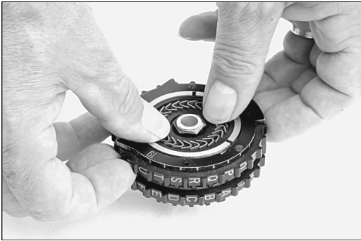
65 Trennen eines Walzenpaares. Die Fingerkuppen greifen zwischen die Walzen, die beiden Daumen drücken auf die Kontakte. Die Zahnscheibe (Zahl) muss auf der Daumenseite liegen. [AUT]
