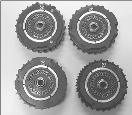
95 Fortschaltwalzen der Botschaftsmaschine TD117 sie sind anders ausgestaltet als diejenigen beim Militär. [AUT]
