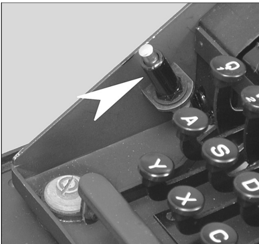
61 Der Hauptschalter (Pfeil). Unten links ist eine der drei Schrauben zu sehen, mit welchen die Maschine auf dem Boden befestigt ist. [AUT]
