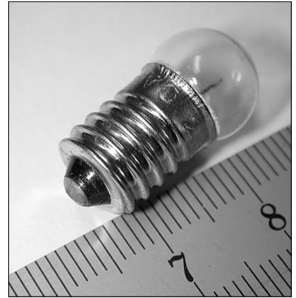
58 Eines der 26 Lämpchen, die im Lampenfeld eingebaut sind. [AUT]
