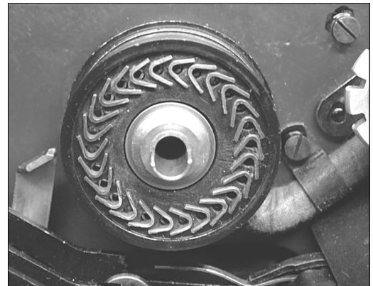
138 Die starre Anschlussplatte für das Walzenpaket. Die Kontakte führen zu den Tasten und den Lämpchen. Die rote Walze ist hier entfernt. [AUT]
