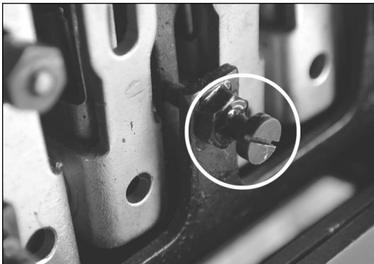
124 Hier ist eine der vier Schrauben zu sehen, mit denen die Vorschubvariante eingestellt wird. [AUT]
