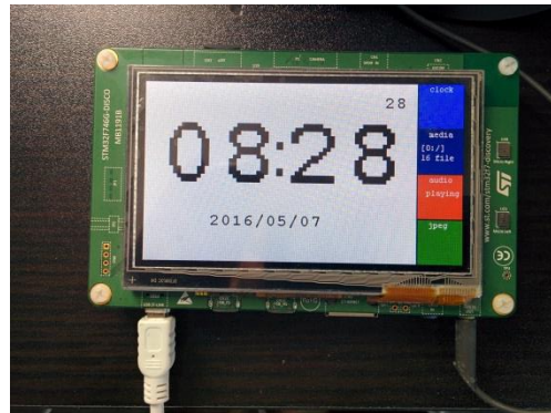
RTCを用いた時刻表示
